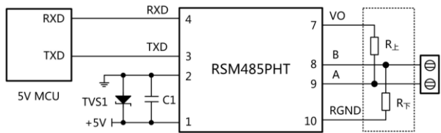
图1.MCU 5V供电应用电路
