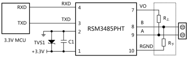
图2.MCU 3.3V供电应用电路
