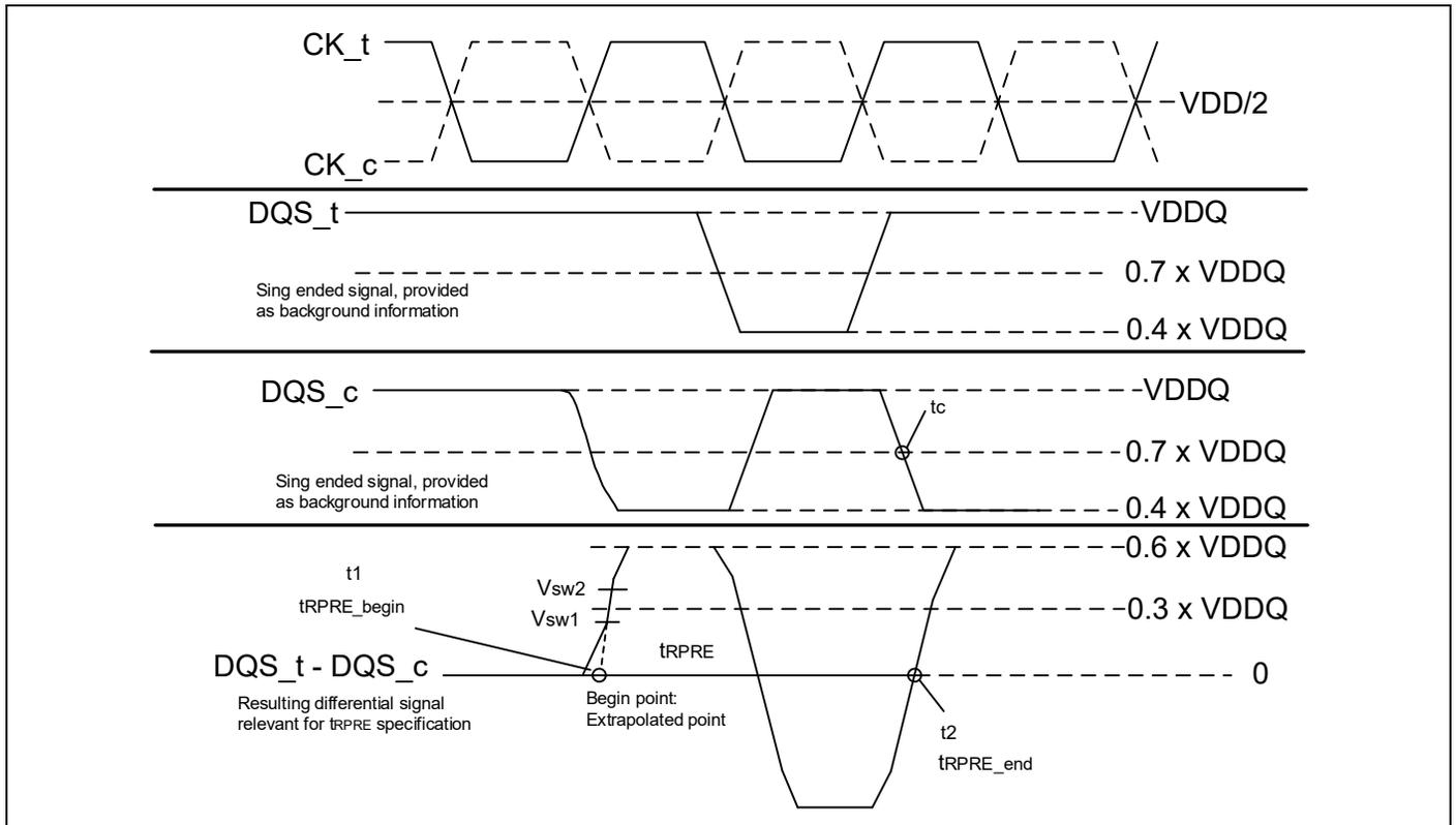
**Note:** Low Level of DQS<sub>t</sub> and DQS<sub>c</sub> =  $VDDQ / (50 + 34) \times 34$
