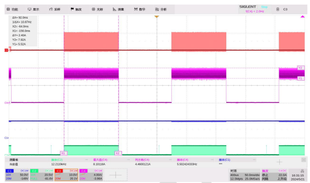
图1: 100Vin/5Vout 输出短路
