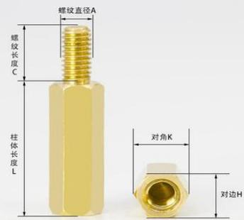
尺寸说明：例如：M3\*16+6 (螺纹直径\*柱体长度+螺纹高度)=(A\*L+C) 单位:mm
