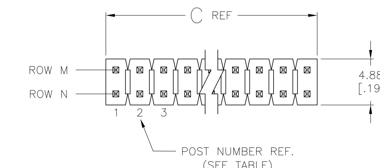
1 TRUE POSITION TOLERANCE OF THE POST TIPS APPLIES WHEN THE HEADER IS HELD FLAT AGAINST THE PRINTED CIRCUIT BOARD.
