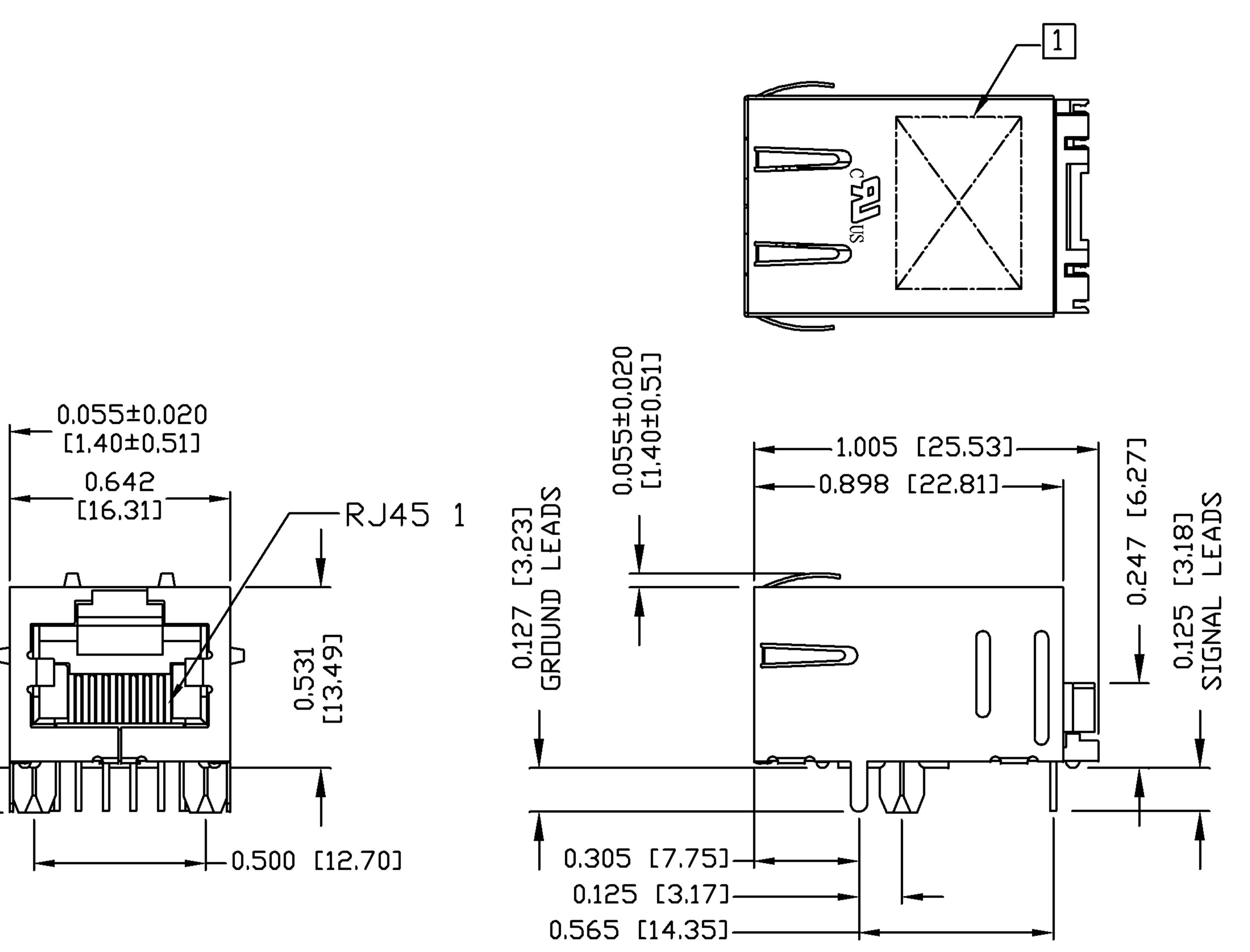
RECOMMENDED PCB FOOTPRINT COMPONENT SIDE VIEW
