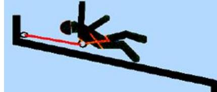
7、锋利器具：请勿将安全带直接接触到会切割，撕裂和磨损的尖锐角或粗糙物表面；当工作于尖锐角和粗糙表面不可避免的环境中时，使用大垫子或其他有保护的栅栏以预防直接接触。
