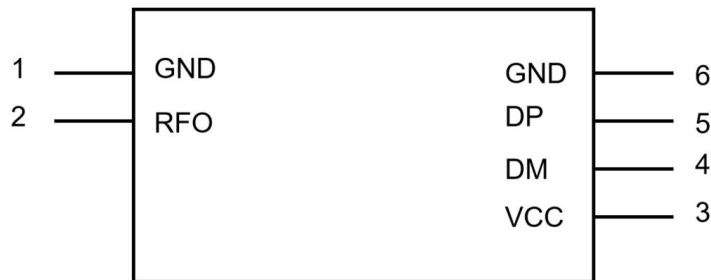
图 2: M573H-USBDG 管脚定义
