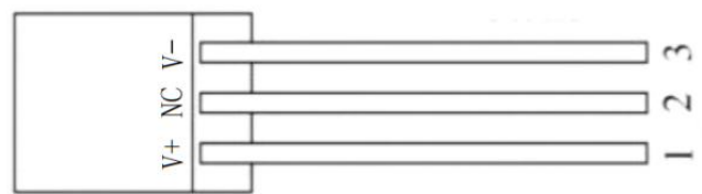
图 2 引脚排列图（顶视图）
