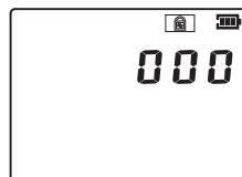
按 **UP** 键输入密码300，按 **ENT** 键进入cal 1校准界面，屏幕显示“**Cal**”和“**1**”符号。将仪表放置在户外的正常空气中按 **ENT** 键，等待3秒钟后再次按 **ENT** 键，屏幕左下角显示“**OK**”，此时完成了空气中氧气含量的校准和其他三种气体的零点校准。按 **ESC** 键返回cal 1校准界面，按 **UP** 键切换到cal 2 校准界面，屏幕显示“**Cal**”和“**2**”符号。
