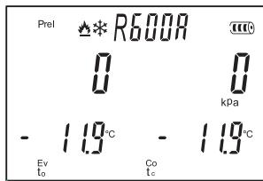
屏幕上方显示压力，屏幕下方显示蒸发温度和冷凝温度。
