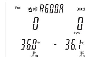
继续按“▼”键切换到蒸发温度和冷凝温度显示界面，
