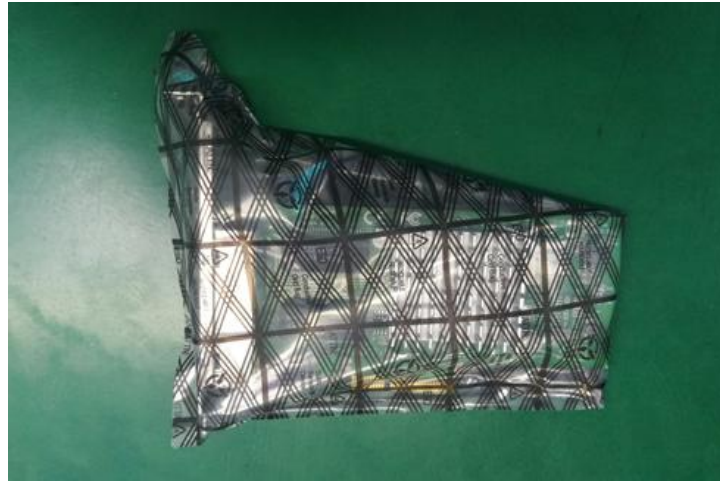
b: 放入蜂巢式包装箱，一个包装箱可以放入网卡54PCS，加泡沫棉。
