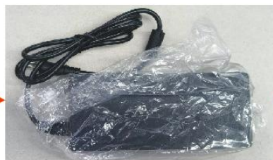
1. 产品放入PE袋 2. PE袋尺寸: L300*W190*T0.06mm
