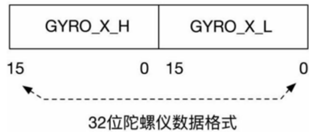
图 14 SPI32 位数据还原示意图
