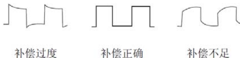
图1—7探头补偿校正
