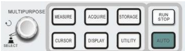
图2-28采样系统功能按键（功能）
