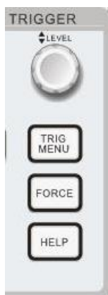
图 1-10 面板上的触发菜单
