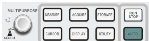
图2-30采样系统功能按键（光标）
