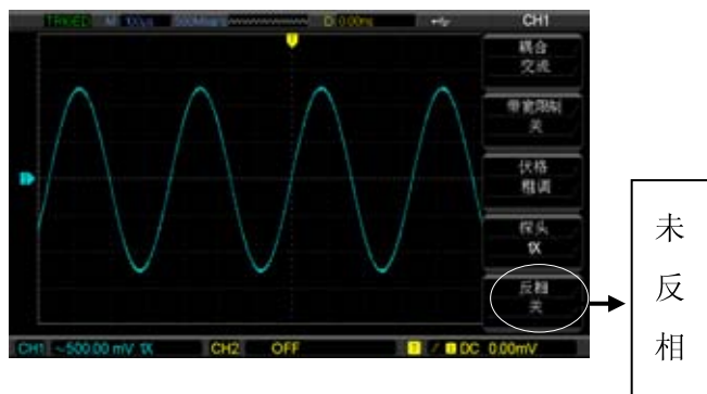
图2-8 垂直通道反相设置（未反相）
