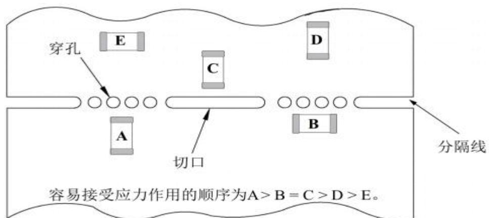
使本产品放在印刷电路板上靠近切口，而不是靠近穿孔。
