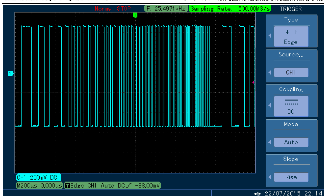
图 4-133 示波器观察扫频波形
