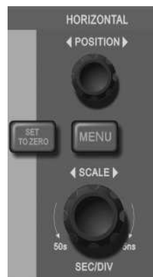
5.7寸屏水平控制面板
