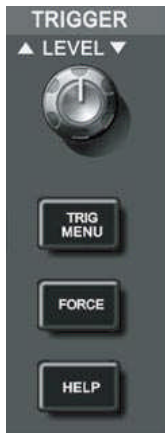
5.7寸屏 图1-11 面板上的触发菜单
