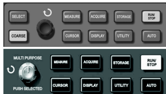
图2-28 采样系统功能按键（自动测量）
