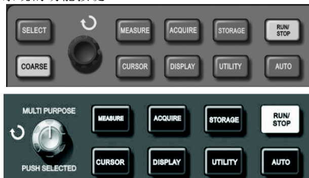
图2-22 采样系统功能按键（存储）
