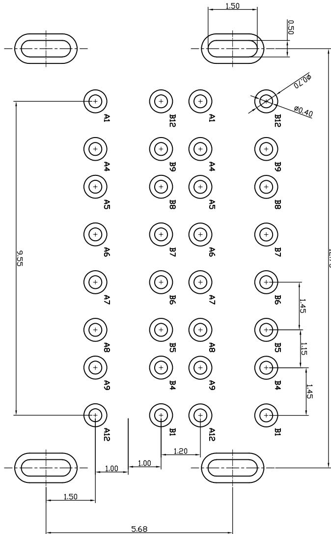
RECOMMENDED PCB LAYOUT(TOP VIEW)
