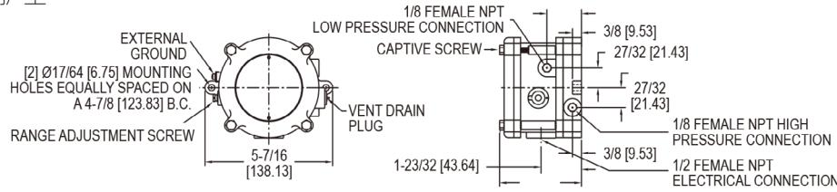
**1950型防爆差压开关** 综合了 1900 系列差压开关的所有性能，再配备防爆或全天候的防护外壳，使其应用更加广泛，应用价值也更高。它有 CE, UL, CSA, FM 认证，级别为 Class I, Div 1, Groups C and D, Class II Groups E, F, and G and Class III hazardous atmospheres (NEMA 7 & 9)。全天候防护盖上带有排水堵头和 O 型环密封。很容易移除前盖来完成电路连接。防护壳体外部的设定点调节使用非常方便。提供 12 种型号从 .03 – 20 in.w.c. (0.0075 – 5 kPa) 还有从 .5 – 60 psi (0.035 – 3.5 bar)。它非常紧凑轻便 – 重量和体积相当于其它单独带防护的防爆开关的一半。
