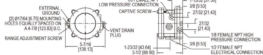
**1950G 系列防爆型微差压开关** 结合了常用的 Dwyer 1950 系列最好性能并且与天然气兼容，可安装在室外并防水。开关通过 UL 认证，可以在 UL 的 Class I 级 A, B, C, D; Class II 级中 E, F, G 中；Class III 级大气中使用，2014/34/EU(ATEX) 适合于 CE，Class II 2G Exd IIB & 气体 T6 和通过 CSA & FM 认证的 Class I 级 Div. 1, B, C, D 组；Class II 级 Div. 1, E, F, G；Class III 级大气 IECEx Ex d IIB + H2 T6 (-40°C < Ta < +60°C)。1950G 体积小，重量和体积相当于常规防爆开关的一半。
