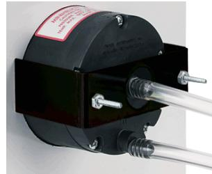
和 MiniHelic® II 一起提供的还有为仪表盘嵌入式安装的安装部件，通过一个直径为 2-5/8" (67 mm) 的单孔。和部件一起提供的部件可以安装到仪表盘的厚度达到 1/2" (13 mm)。如果有必要，可以将两个 4-40 的螺钉旋入压力表背部的安装支架的螺孔中，来进行压力表的表面安装。表面安装需要在嵌板上为两个压力接头预留空间。
