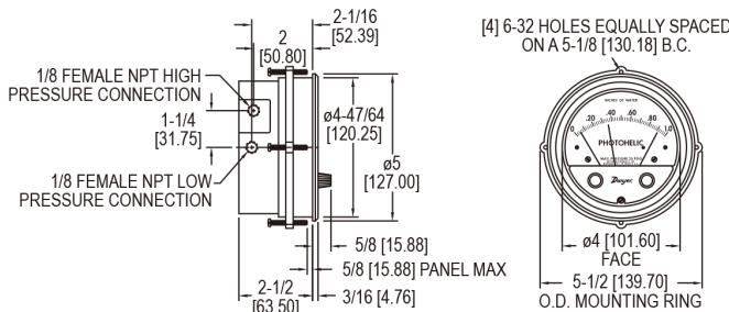
3000MR 3000MRS Photohelic® 开关 / 表把高精度、高重复性能的差压开关与大表盘便于读数的指针式差压表结合到一起，采用了可靠耐用的的 Magnehelic® 设计理念。可通过仪表面板的旋钮设置压力开关设定点，压力表读数不受开关的影响，即使失电也能准确读数。采用了固态技术大大减小了产品的体积和重量。可在 13/16" (122 mm) 安装孔中被嵌入安装或用带有的附件进行表面安装。3000MR 型采用了镀金触头开关，特别适用于小功率无源电路。对于开关动作频繁的应用场合，可选择带单刀单掷（常开）固态开关的 3000MRS。有高低位开关，带 18 英寸 (45 cm) 长的电缆用于电气连接。
