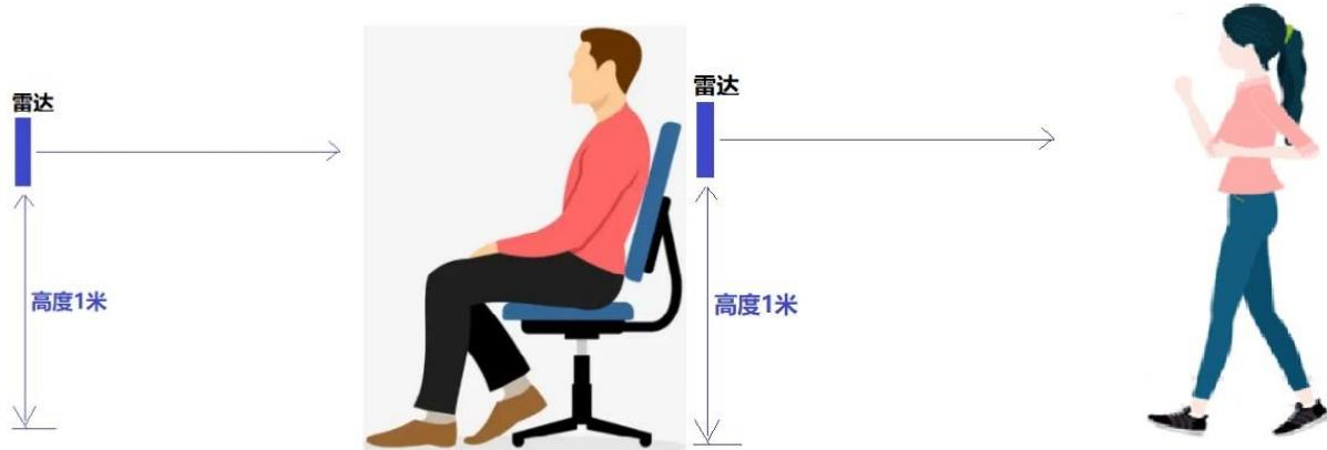
蓝色区域内为移动感应区（图示中的最大移动距离，需要将  $r_{max}$  设置大于 9 米）；橙色区域内为静止存在感应区。
