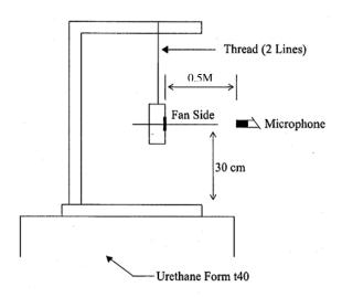
0.5 METER FROM MICROPHONE TO FAN INTAKE
