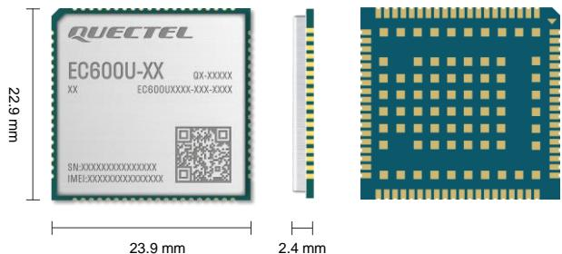
EC600U 系列是移远通信推出的 LTE Cat 1bis 无线通信模块，采用 3GPP Rel-13 LTE 技术，支持最大下行速率 10 Mbps 和最大上行速率 5 Mbps，具有超高性价比；同时在封装上兼容移远通信 LTE Standard EC600E-CN、EC600G 系列、EC600M 系列和 EC600N-CN 模块，实现了 2G 网络到 4G 网络之间的无缝切换，以满足不同行业产品应用需求。
