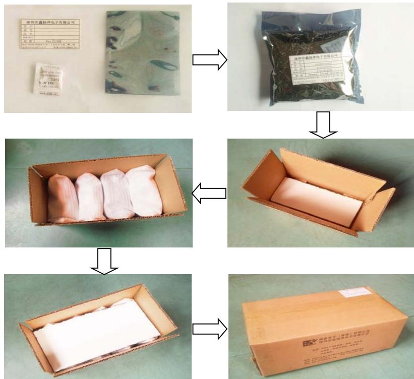
3，填充完成后，折好包装箱上盖，用透明胶带将包装箱的中缝和两侧缝处封牢，透明胶带切口要平整，且完全与纸箱粘在一起若有不平要用手将其抹平。最后将外标签贴于包装箱的右上角，包装完成。
