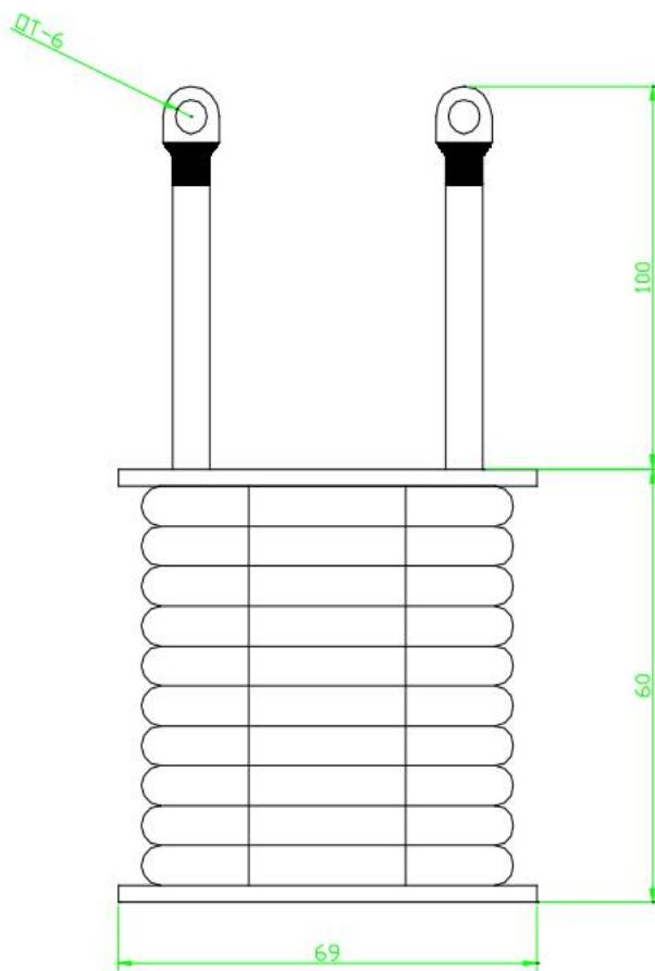
绕组原理 (Winding schematic diagram) :
