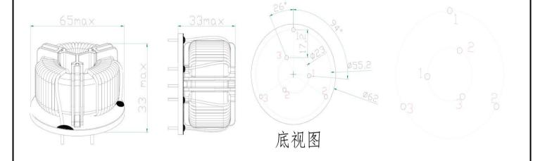
1.2 (SCHEMATIC) 线圈联线图:
