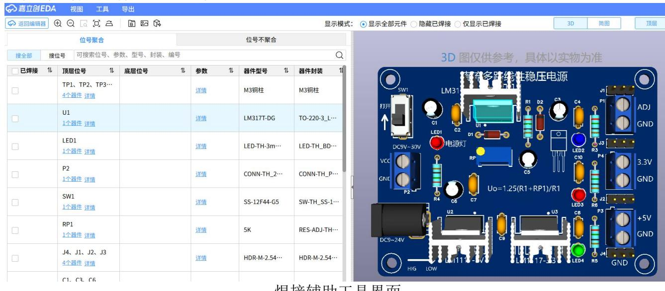
焊接时参考以下顺序依次焊接，先焊接芯片座再安装芯片，谨防芯片安反，使用万用表检查无短路，电解电容方向焊接正确方可上电，防止接错电容爆炸。
