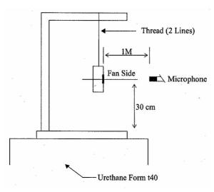
1 METER FROM MICROPHONE TO FAN INTAKE
