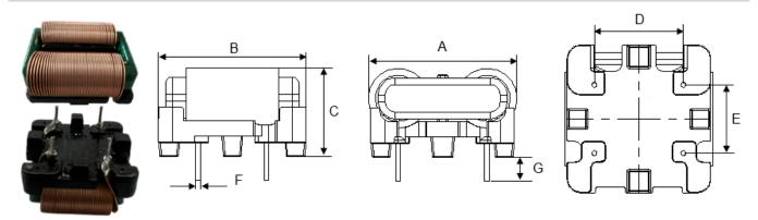
PCB aperture ≥ Ф 1.2mm
