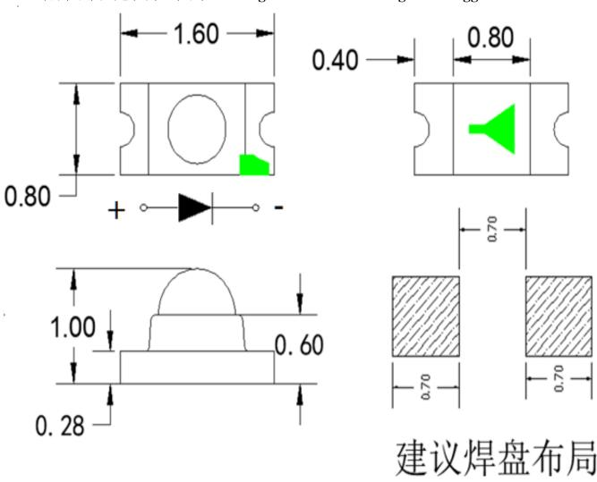
注/ Notes: 1. 单位 : 毫米 (mm) / All dimensions are in millimeters
