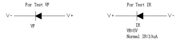
10.6.3 顺向电压 VF 过高或反向电压 VR 过高,均会损坏 LED.
