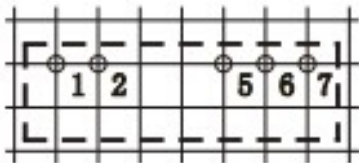
俯视图,栅格间距 2.54mm 开孔直径 1.00mm
