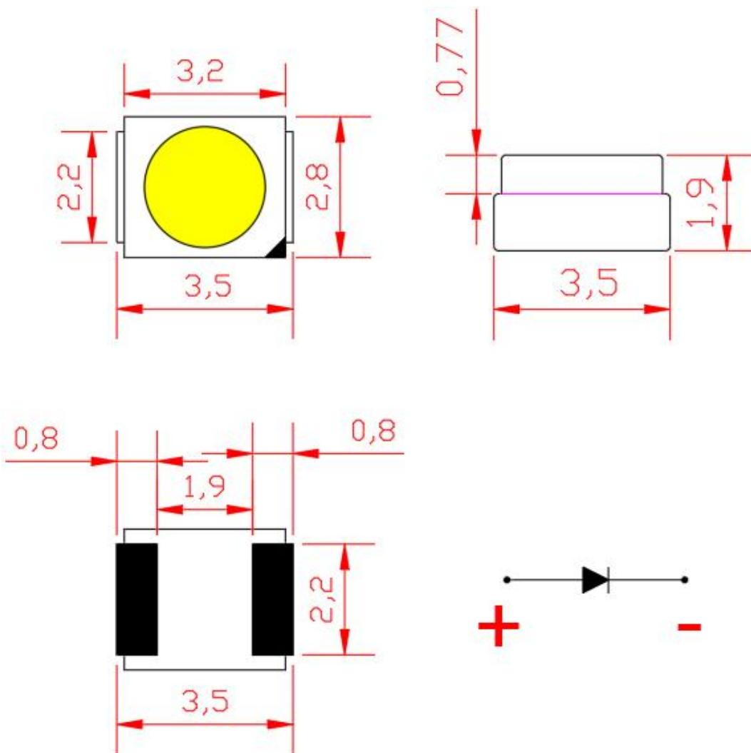
说明：①所有标注尺寸单位为毫米（All dimensions are millimeters）；
