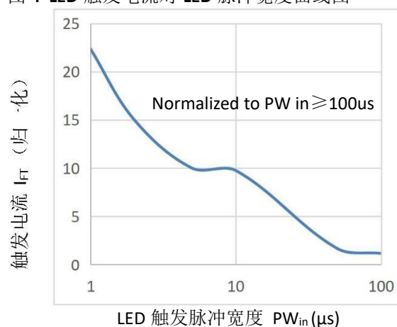
图 4 LED 触发电流对 LED 脉冲宽度曲线图
