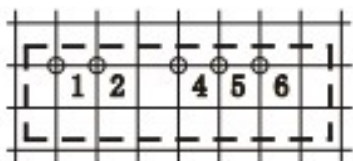
俯视图,栅格间距 2.54mm 开孔直径 1.00mm
