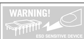
**注意：**本产品为静电敏感元件，请注意防护！ESD 损害的范围可以从细微的性能下降扩大到设备故障。精密集成电路可能更容易受到损害，因此可能导致元件参数不能满足公布的规格。
