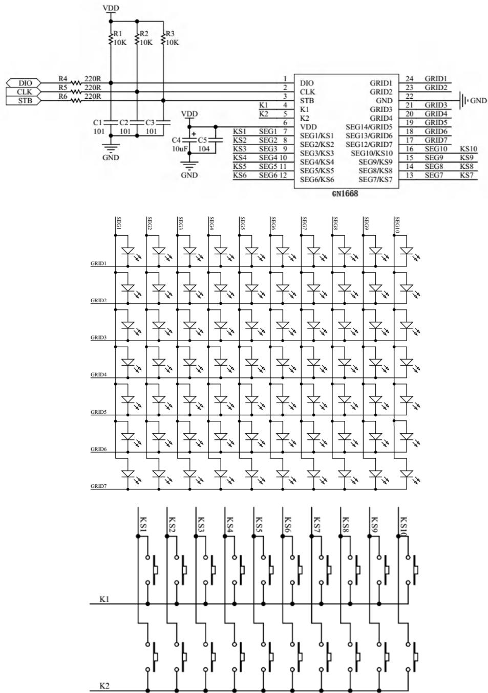
注：1、VDD与GND之间的滤波电容应靠近GN1668，以加强滤波效果。
