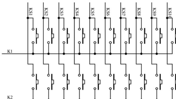
键扫数据储存地址如下所示，先发读键命令后，开始读取按键数据BYTE1-BYTE5字节，读数据从低位开始输出，其中B6和B7位为无效位固定输出为0。芯片K和KS引脚对应的按键按下时，相对应的字节内的Bit位为1。
