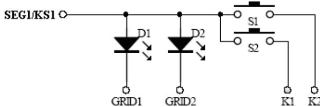
2、在SEG1-SEGn上面串联电阻，电阻的阻值应选在510欧姆，太大会造成按键的失效，太小可能不能解决显示干扰的问题，如下图所示：
