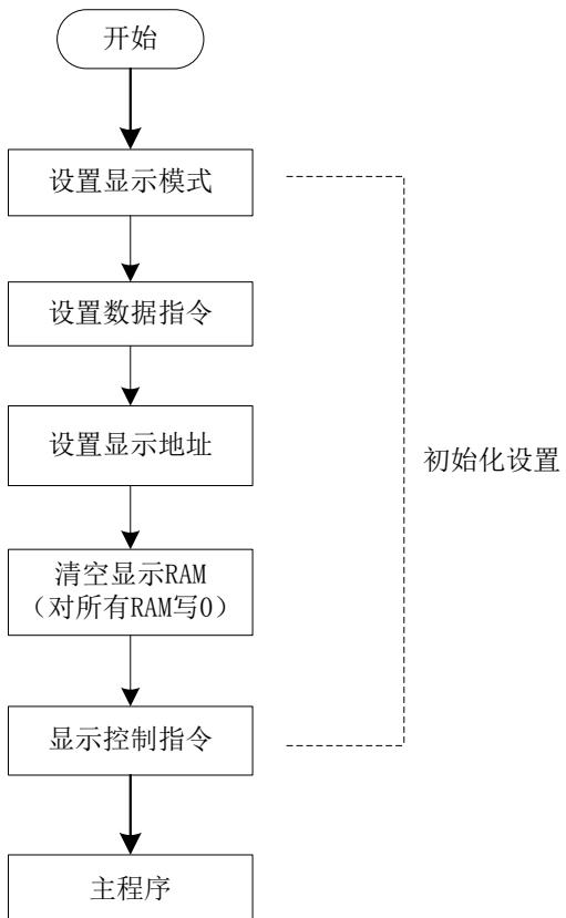
注：1、显示模式设置用来选择驱动显示屏的段位数，需根据用户实际的硬件连接来选择，一般只在初始化部分设置。
