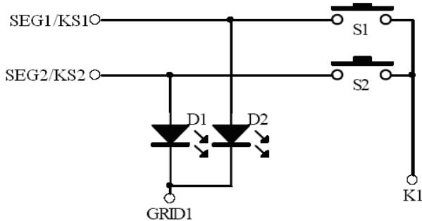
1、在硬件上，可以将需要同时按下的键设置在不同的K线上面，如下图所示：
