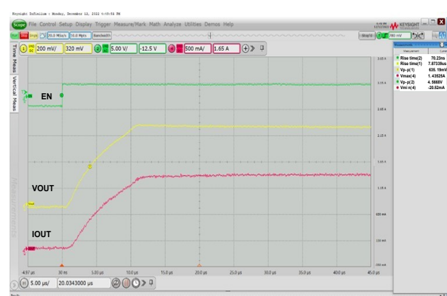
Enable power on: Iout=1.5A
