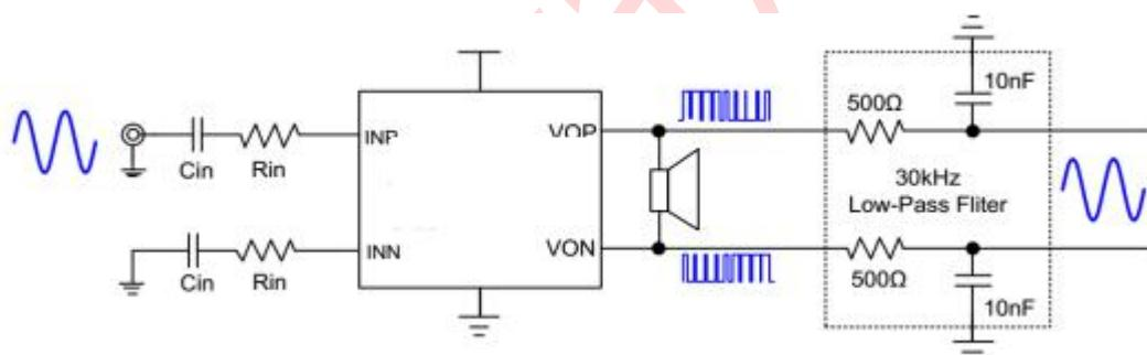
注：测试 D 类时必须加低通滤波器，一般由 33uH 电感和 1uF 电容构成。为减小功率损耗和干扰噪声，让测试数据更加精准，测试 NS4205 时可选用电阻电容做滤波器，电阻值选 500Ω，电容值选 10nF。
