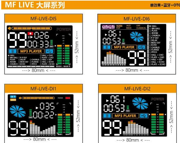
双工异步声卡功能。封装采用标准 DIP36 插件封装，间距为 2.0mm，同时，我们还同时设计了，多款不同的 UI，供工厂选择，目前有 4 款 UI 如上图所示。
