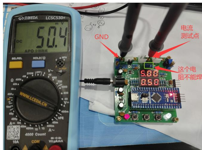
我们没法让仪器直接“抓着电流看大小”，但能通过一个“中间帮手”把电流变成能测的电压——这个帮手就是“采样电阻”。首先，我们会把这个电阻串联进要测的电路里，根据欧姆定律（电压 = 电流 × 电阻），电流流过电阻时，电阻两端一定会产生电压，而且电流越大，这个电压就越大，两者是严格成正比的。这就意味着，只要测出电阻两端的电压，反过来就能算出电流，根本不用直接碰电流本身。
