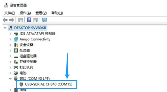
图 5.1.2 设备管理器检查 COM 端口
