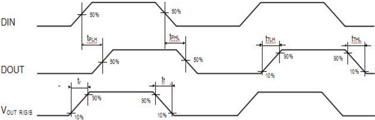
IC 动态参数测试示意图
