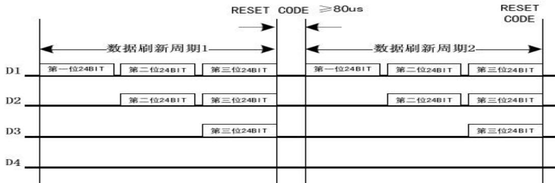
注：其中 D1 为 MCU 端发送的数据，D2、D3、D4 为级联电路自动整形转发的数据。
