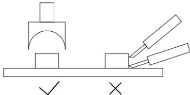
烙铁应使用如下图的方式作业。
