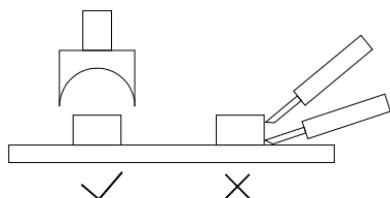
烙铁应使用如下图的方式作业。
