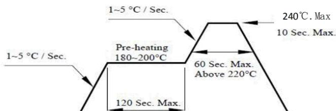
4、回流焊接次数不可超过 1 次，建议检查终端产品是否需要经历二次回流焊工艺，二次回流焊工艺具有一定品质风险性，如需请自行评估并尽量缩短二次回流焊间隔时间（建议不超过 4 小时）。
