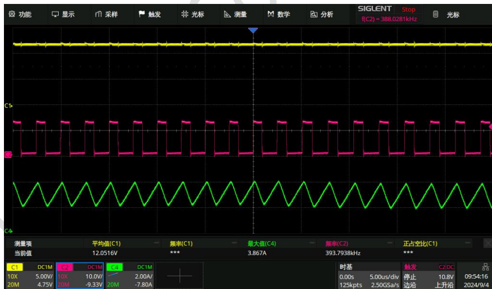
CH1 VOUT; CH2 SW; CH4 IL 输入 5V, 输出 12V1A
