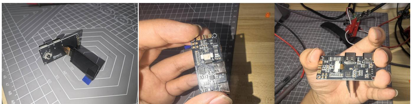
3. 无论是否使用外壳，可使用双面胶/泡棉胶或热熔胶固定屏幕，**应注意，屏幕外壳是金属材质，请勿与 PCB 的电源输出焊盘接触，从而导致短路。**
