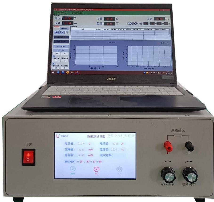
DX-20030 系列端子线束电压降测试仪概述：本系统采用高精度可调恒流源输出检测连接器件的电压降，根据欧姆定律可计算出接触电阻，接触电阻的大小是车用电线束连接器和接插件在强电流电路和弱电流电路下电性能好坏的评定指标；在恒定电流状态下，通过测试导线压接端子接触区域的电压降，
